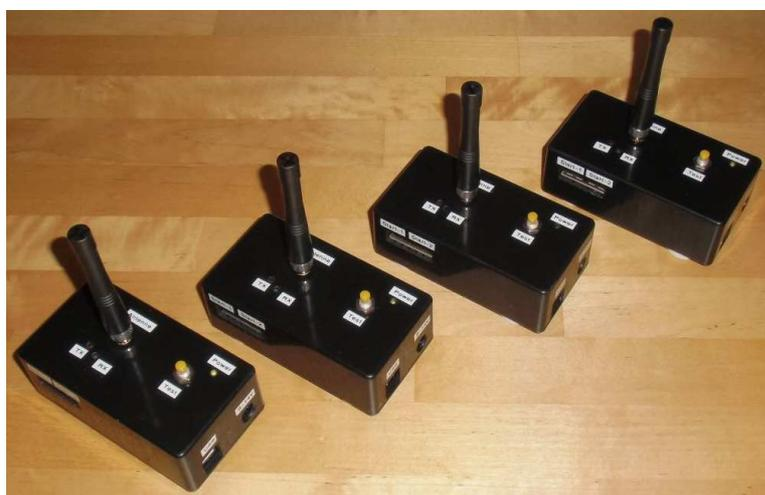
Diese Funkmodule verfügen über die systemüblichen USB-A Schnittstellen und lassen einen direkten Anschluss von bis zu 4 Sensormodulen zu. Die Funkübertragung erfolgt im 433MHz Frequenzband, ist digital codiert und sehr schnell und durch Adressen der Funkmodule definiert.
