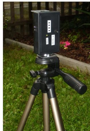
Die Montageplatte ist mit einem Kamera-Adapter am Stativ befestigt und kann leicht abgenommen werden.
