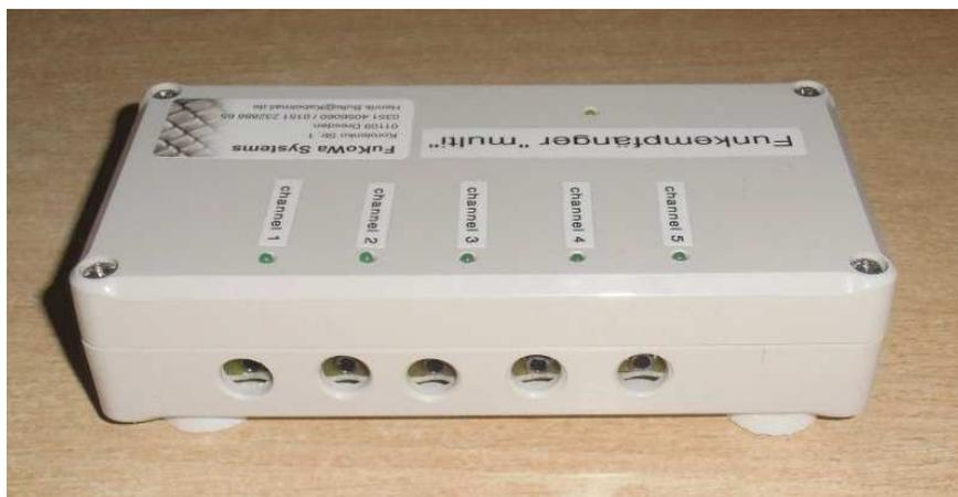
Funkempfänger „multi“ für bis zu 5 parallele Funkverbindungen
