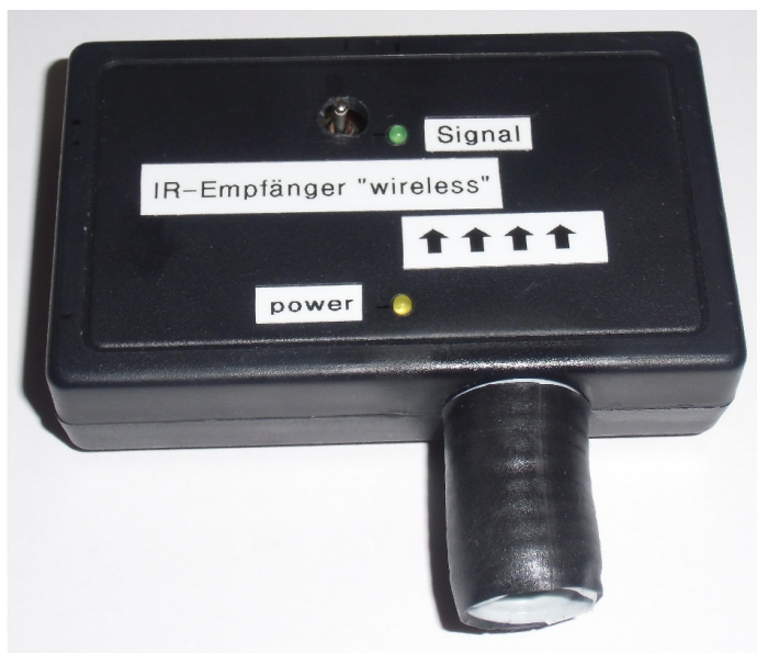
Lichtschranken-Empfänger „wireless“ mit Diffusor
