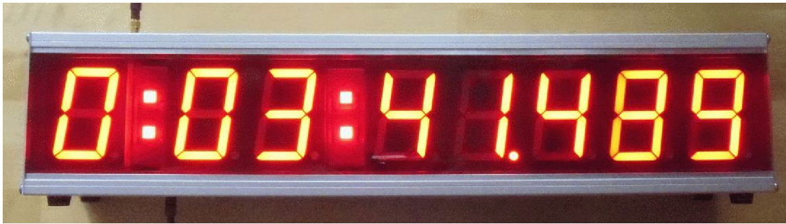
3" 8-stelliges LED Großdisplay mit 75mm Ziffernhöhe und Digitalfunksteuerung
