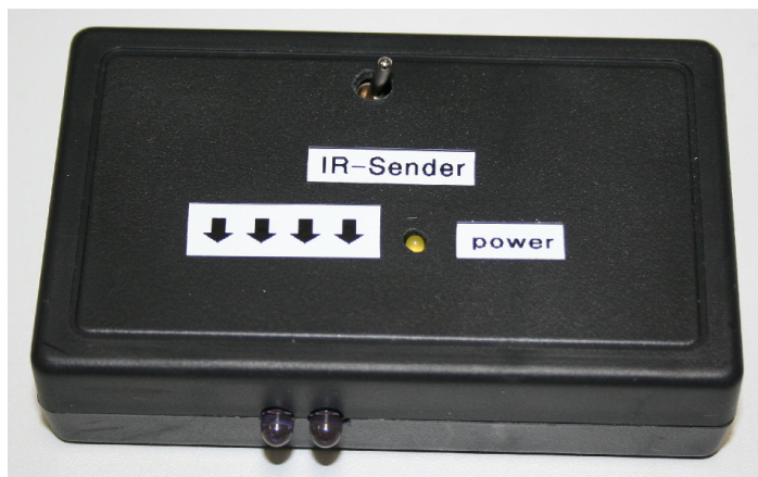
Lichtschrankensender (950nm, 38kHz) hier mal ohne Diffusor
