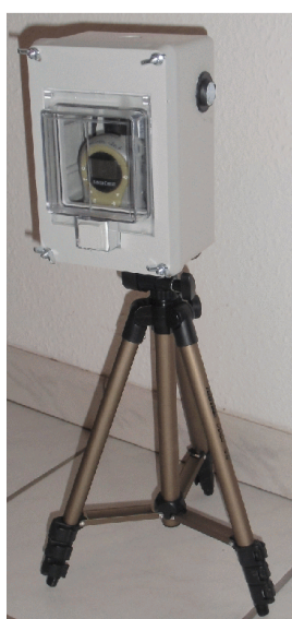
Module in IP65 Schutzgehäusen für Einsatzfälle in Verbindung Wasser und Verschmutzung
