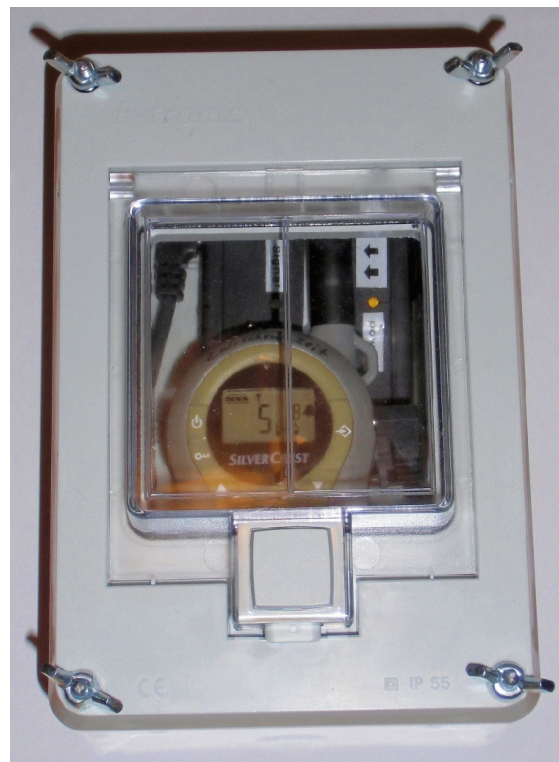
Kontaktmodul „wireless“ in IP65 Schutzversion
