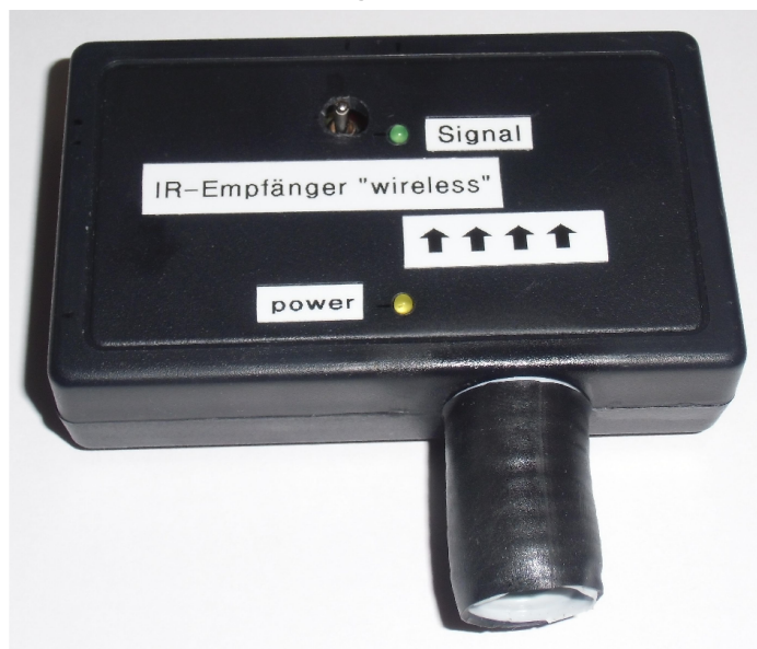
Lichtschranken-Empfänger „wireless“ mit Diffusor
