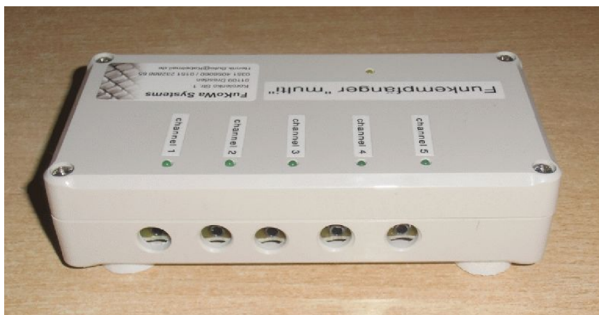
Funkempfangsgeraet „multi“ für bis zu 5 parallele Funkverbindungen
